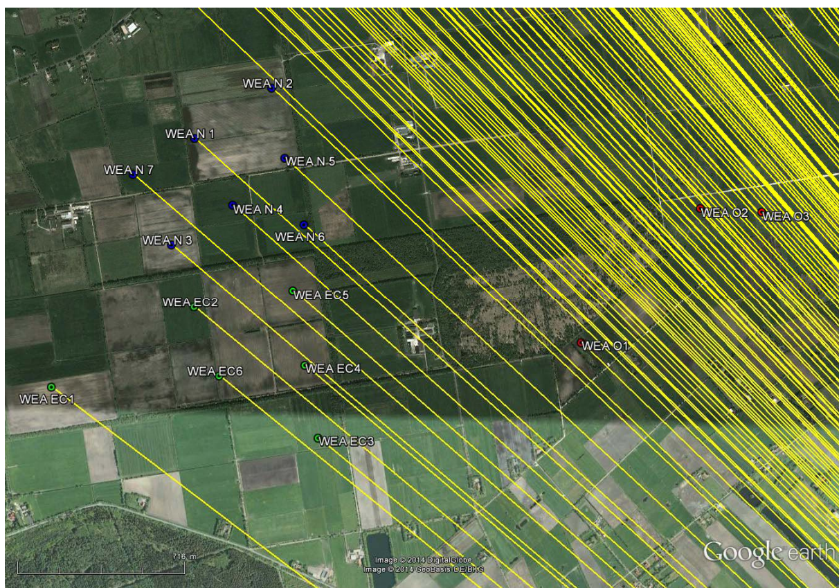
Abbildung 1: Gesamtübersicht des Windparks Aurich-Holtriem der geplanten zulässigen Windenergieanlagen (grün) sowie der Fremdplanung (blau). Die rot gekennzeichneten Windenergieanlagen im östlichen Gebiet sind radartechnisch nicht zulässig. Die Einstrahlungsrichtungen bzgl. der Radaranlage Brockzetel sind gelb dargestellt.
